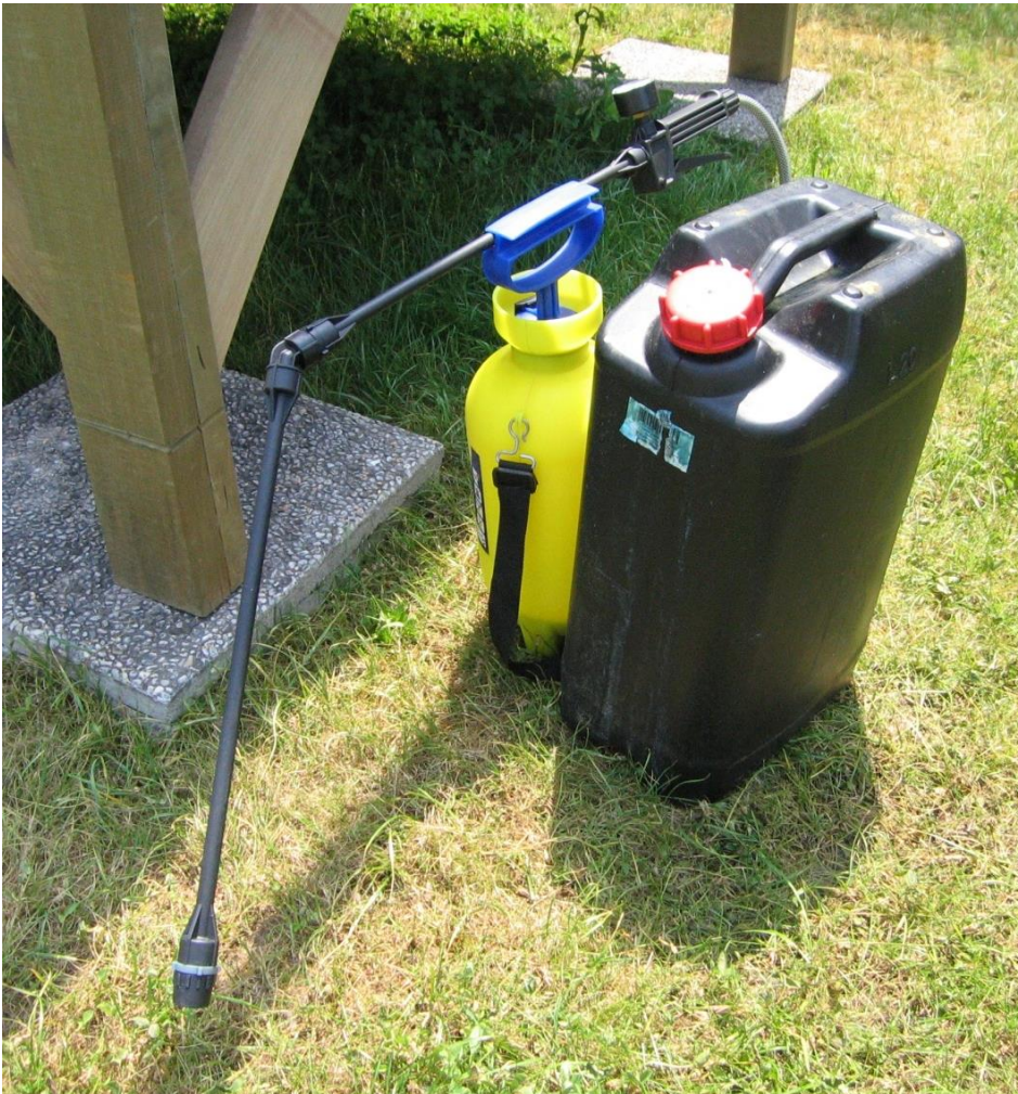
Slika 8: Vrtnarska škropilnica, ki jo lahko uporabimo za nanos biocidnega proizvoda na les.
