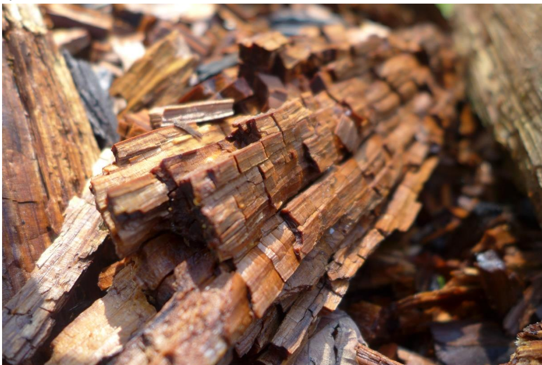
Slika 20: Prizmatično razpokan in rjavo obarvan les je značilen za razkroj z glivami rjave trohnobe
