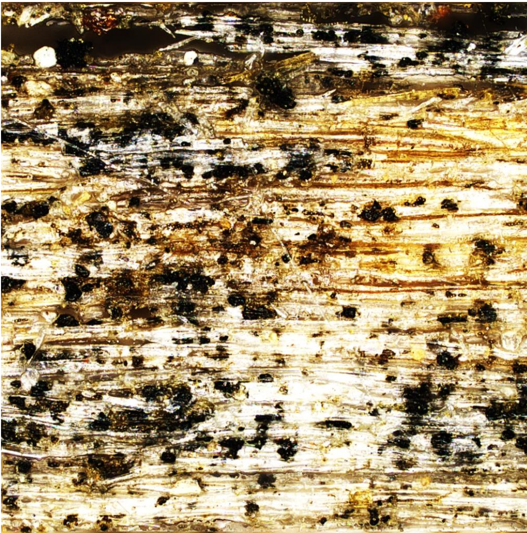
Slika 19: Temni melaminski pigmenti na površini pomodrelega lesa. Les je bil 18 mesecev izpostavljen vremenskim pogojem na terenskem polju Oddelka za lesarstvo (površina 256 \mu\text{m} \times 256 \mu\text{m} )
